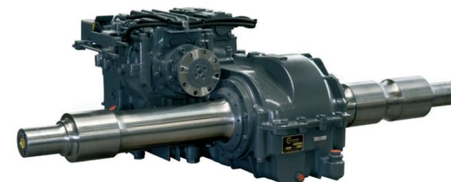
Stirn-Kegelradgetriebe mit Wendschaltung für diesel-mechanisch angetriebene Triebwagen
