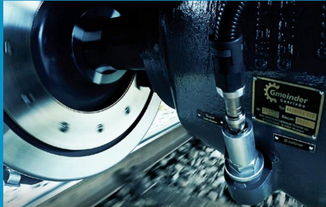
Das Gearbox Condition Monitoring System GGT-GearSaver® ist ein von der Firma Gmeinder entwickeltes Produkt zur automatischen Überwachung von Radsatzgetrieben.
